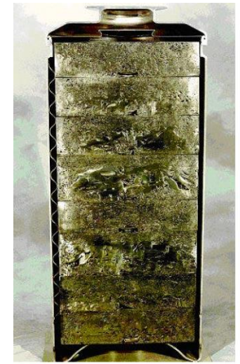
exemple d'empilement de galettes de déchets compactés dans un CSD-C
