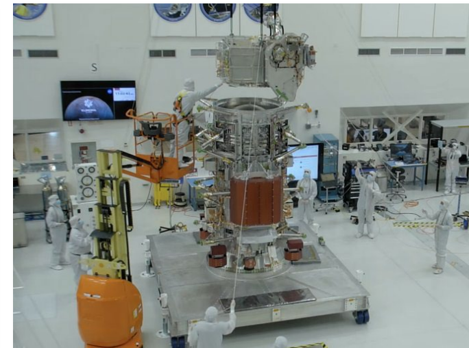
Avionics module atop the propulsion module
