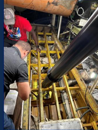
B777 Dropsonde/Sonobuoy Tube Installation
