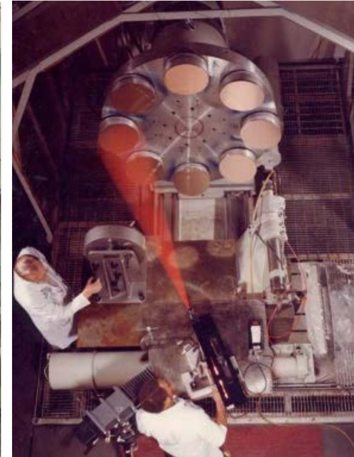
D=2m diamond turning machine at Oak Ridge N. L.
